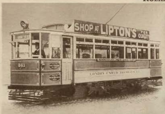
Przeciw wsiadaniu i wysiadaniu z tramwajów w czasie jazdy. W Londynie zaprowadzono już przy tramwajach urządzenie automatyczne, które z chwilą ruszania wozu natychmiast zamyka wejście do niego i podnosi stopnie, natomiast równie automatycznie umożliwia wyjście z wozu, gdy on stanie. Atlantic.
