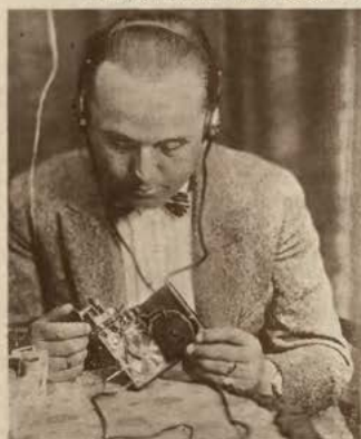
Radio w papierosnicy: Miniaturowy aparat, pozwalający na odbieranie fal głosowych w promieniu 40 km. Atlantic.
